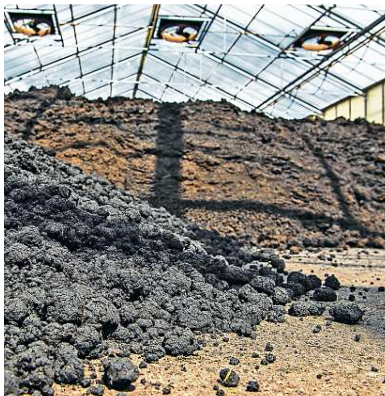
Bevor der Schlamm abgeholt wird, muss er entwässert und gepresst werden. Dann geht es weiter zur Verbrennungsanlage. FOTO: NICOLAS ARMER/DPA
