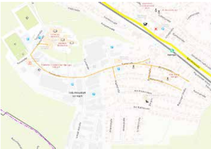
Erste Ausbaubaustufe des Nahwärmenetzes
